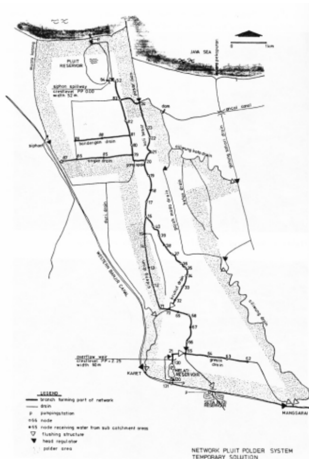
Figuur 8. Schematisering van het stedelijke waterbeheersing systeem van de Pluitpolder (Kop et al., 1983)
